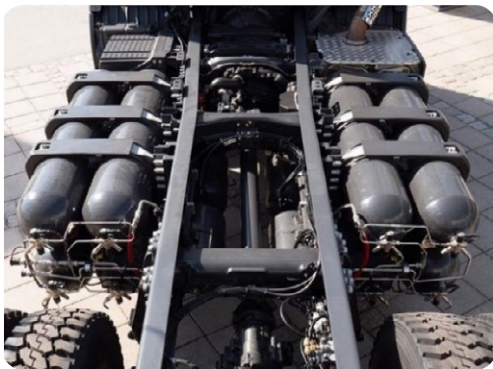
Fig. 1 - Réservoir CNG dans un cadre fixé au châssis du véhicule
